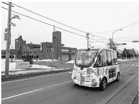
町道を走る自動運転バス。左の電柱に設置された「路車協調システム」のカメラが交差点に接近する車両や人を検知、バスに情報を伝達している
